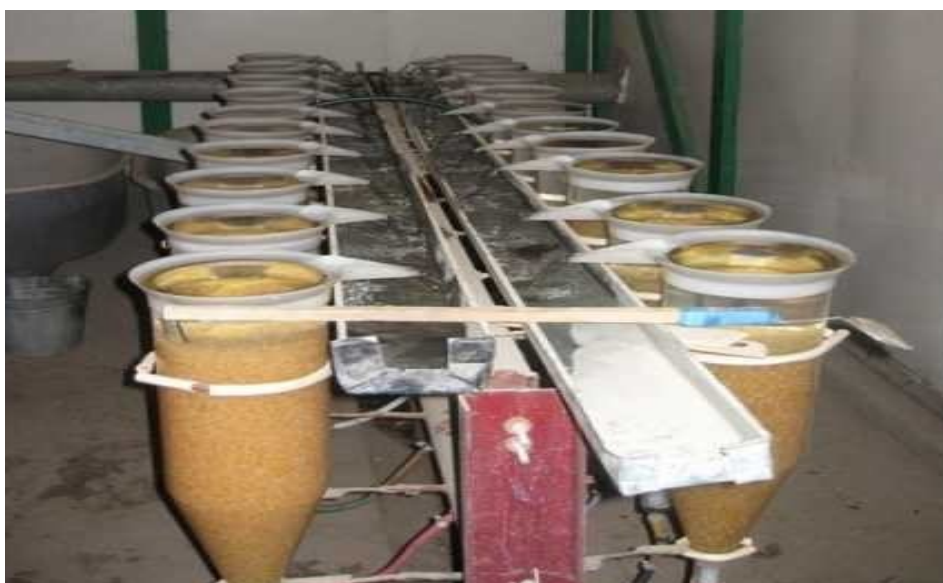
Рис. 1 Общий вид стойки с аппаратами Вейса
